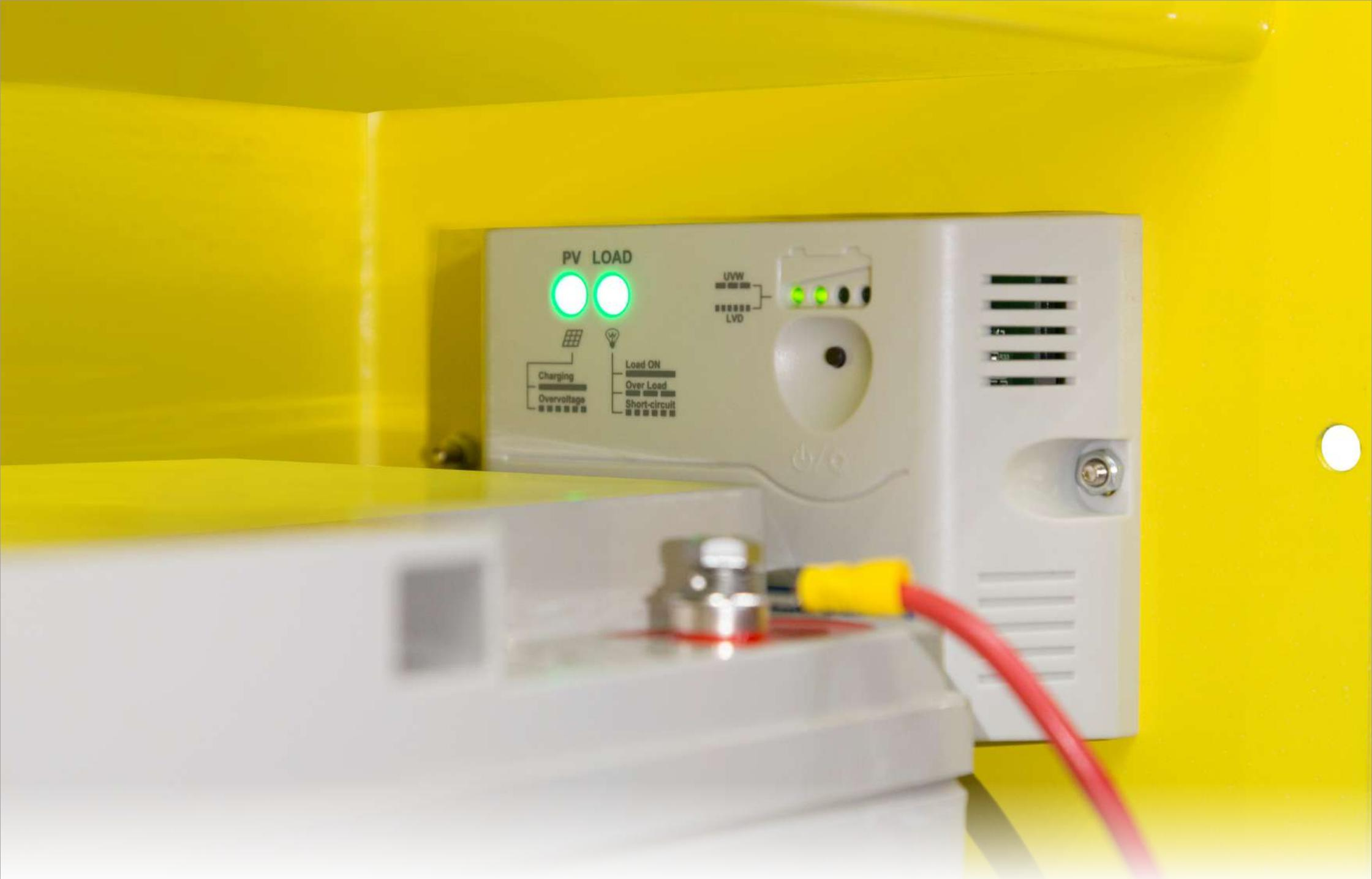
При правильном подключении соединительных кабелей солнечной электростанции с ящиком АКБ, на контроллере загорается зеленый индикатор «PV».
