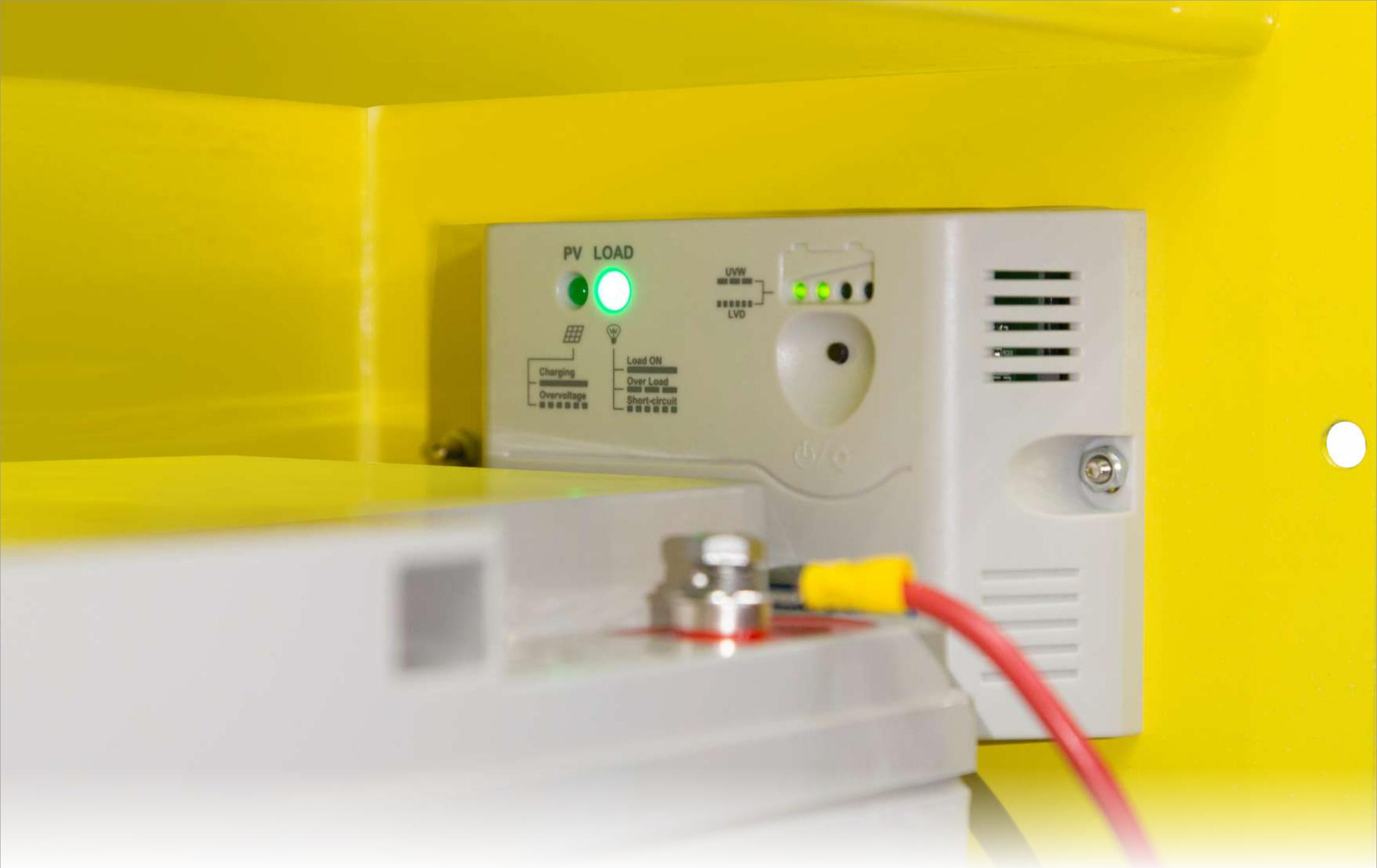
При правильном подключении аккумуляторной батареи, на контроллере загорается зеленый индикатор «LOAD».
